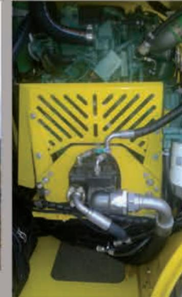
L'azionamento della coclea è idraulico a comando elettronico, un potenziometro permette una velocità di rotazione da 0 a 55 giri minuto agevolando così l'impostazione della velocità desiderata, inoltre si può scegliere la prima marcia da 0 a 30 giri, o la seconda da 0 a 55 giri, anche lo scarico nella fase finale è agevolato da questa soluzione, infatti portando il motore diesel al massimo della rotazione e impostando la coclea a 55 giri/minuto si ha lo svuotamento totale del prodotto lavorato.
