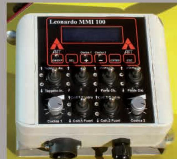
**NUOVO IMPIANTO IDRAULICO CON ELETTROVALVOLE E POMPE A PORTATA VARIABILE AZIONABILI INDIPENDENTEMENTE E DOTATE DI DUE POTENZIOMETRI PER LA SELEZIONE DEI GIRI DESIDERATI DA 0 A 50 g/min**
